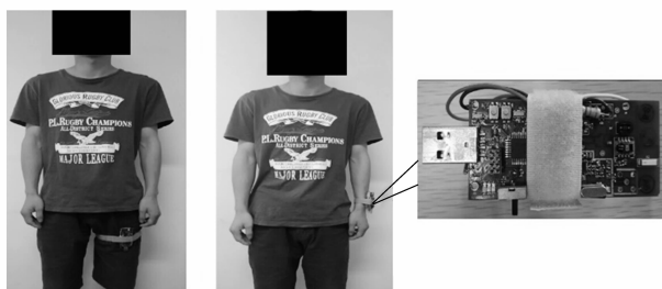
图1 参加实验的志愿者及ADXL345三轴加速度传感器
